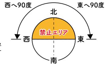
2階建て以上の場合の下屋・1階屋根の傾斜の向きが真西～南～真東までの範囲とし、真西・真東より北へ向いた1階屋根（上図オレンジ色の範囲）への設置はできません。なおかつ、左記の屋根共通条件で該当する場合も設置ができません。
