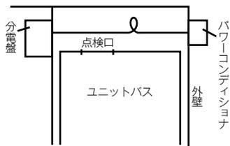
出力制御エリアではLAN線配線を送信ユニットからLANルーター位置まで配線しますので左図のように点検口等を活用できない場合はモールで施工します。
